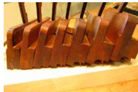
Pomocou týchto hoblíkov sa vyrábali ozdobné lišty.
