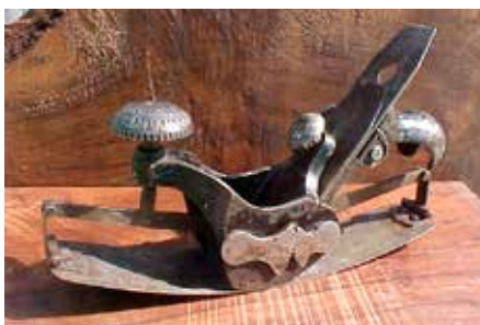
Hoblík Stanley č. 113 umožňoval pomocou nastaviteľnej podstavy hoblňovať aj oblúkové plochy.
