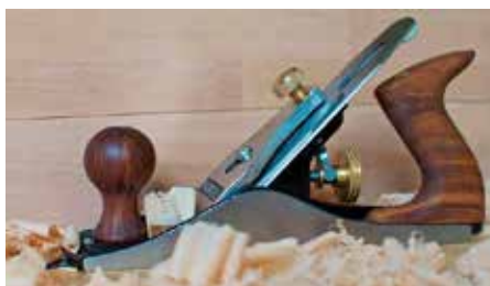
Klasický tvar hoblíka s liatinovým telom a drevenými rúčkami.
