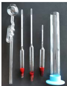
Sada pre vinárov (obsahuje kvasnú zátku, muštomer, liehomer, vinomer a odmerný valec)
